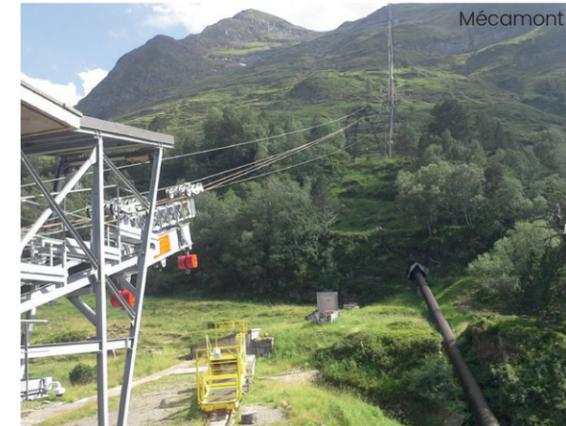
Téléphérique (blondin) de l'usine Portillon permettant d'acheminer des charges en altitude
