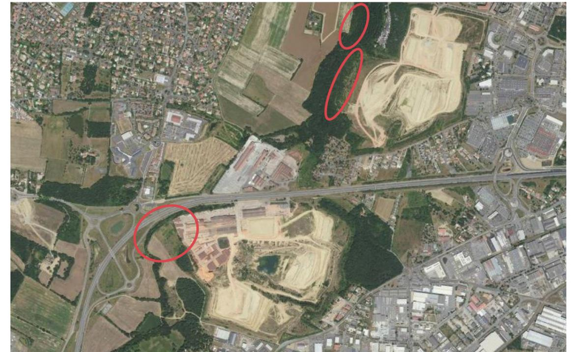
Les environs de Pibrac en 2002 (source IGN): enrichissement des abords des carrières, suppression des alignements d'arbres le long de la N124 lors de son élargissement, détournement du cours d'eau et de sa ripisylve lors de la construction de l'échangeur.
